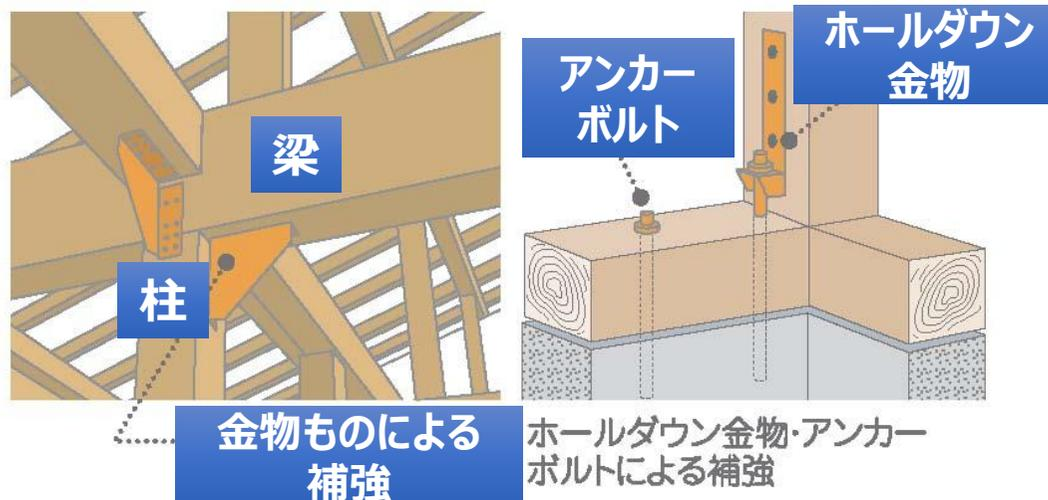
基礎が弱いと土台が基礎からずれたり等、倒壊の危険性が高くなるので、鉄筋を配置した丈夫な基礎にする
