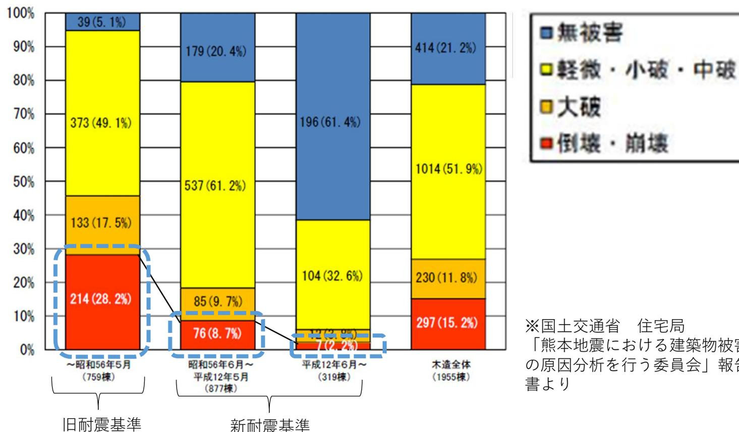
新耐震基準は旧耐震基準と比較して、倒壊・崩壊が減少していることから今回の地震に対する倒壊防止に有効であった。なお、新耐震基準導入以降のものについては、接合部の仕様が不十分であったものに倒壊が多くみられた。
